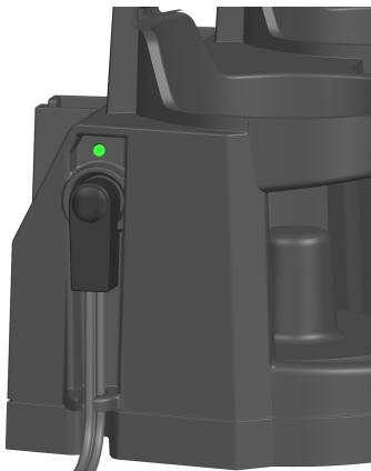
Conecte el cargador a la fuente de alimentación del barco (12–24 V CC). El cable acanalado es el terminal negativo y el pin central es el terminal positivo.
